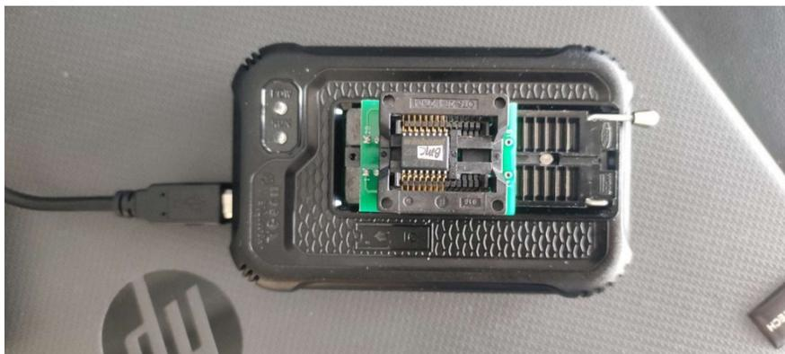
Рисунок 1 – Установка флеш-накопителя в программатор
